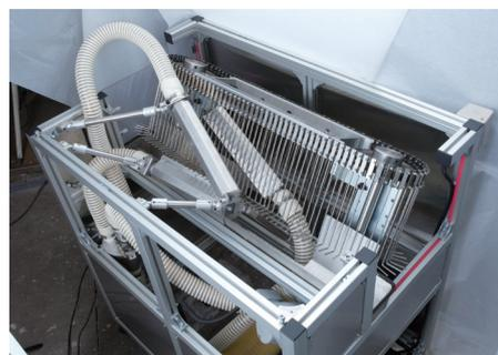
機械内部へのアクセス性が良く、内部の清掃が簡単、またノズルはスリットタイプなので、カルキつまりの清掃も容易に可能。
