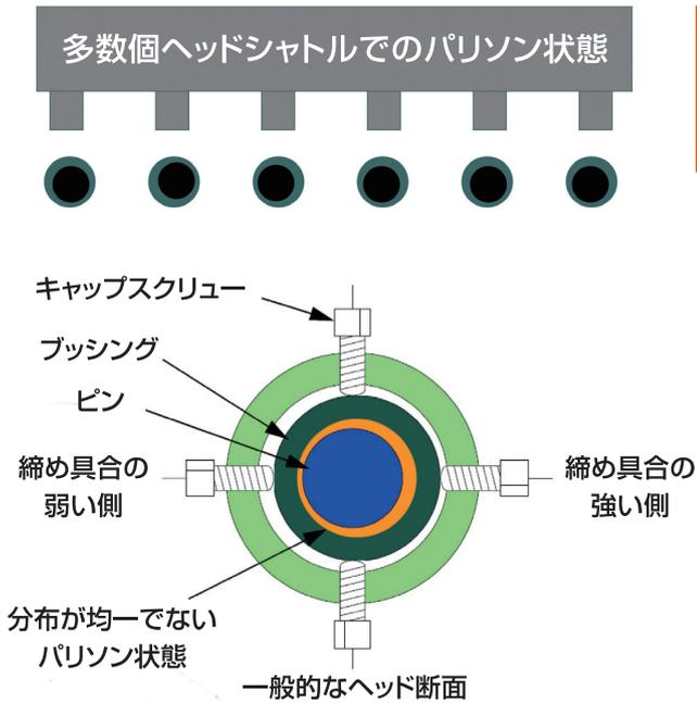
ヘッドは固定マンドレルで90℃毎にヒーターが入っており、常に樹脂の流れを監視、調整することができるGECの特許技術により安定した芯出しが可能
