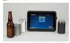
プレッシャーQCはペットボトル、缶容器、ガラス瓶専用にデザインされています。最大限のライン効率化=無駄を省くお手伝いを致します。また、アクリル製ダミーボトルの周りには圧力検知フィルムが搭載されており、ライン上で容器に掛かる圧力を計測致します。取得したデータに関してはワイアレスで付属のタブレット端末に送信され、簡単に閲覧ができ、オンラインソフト上での解析も可能です。トラブル発生時にはラインを停止させずに問題個所を特定する支援となります。プレッシャーQCにより、予期しないラインの長時間停止の予防につながります。
